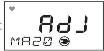
電流計を接続し、 $\Delta$  または  $\nabla$  ボタンで 4mA を調整した後、**SET** ボタンを押します。
