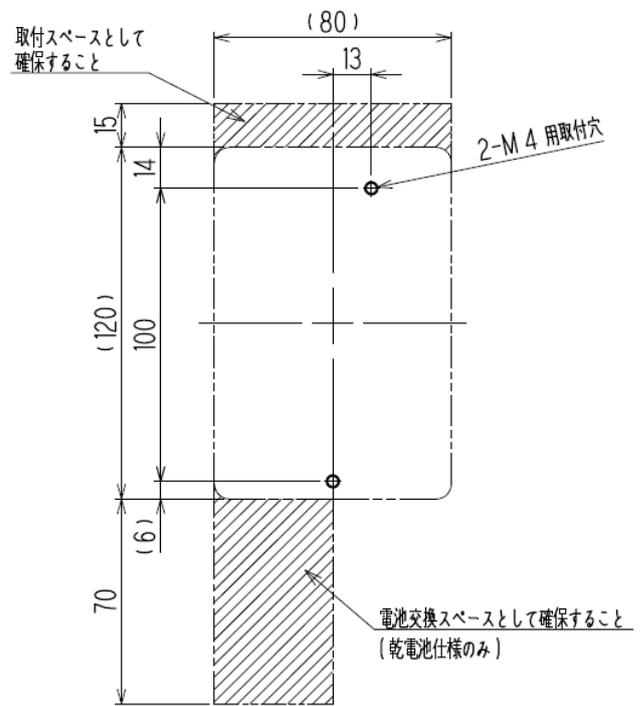
取付寸法図 (取付板使用)
