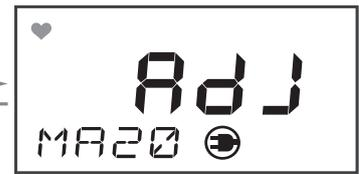
電流計を接続し、 $\Delta$  または  $\nabla$  ボタンで 20mA を調整した後、**SET** ボタンを押します。
