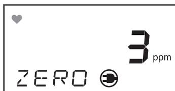
ゼロ調整用ガスをセンサに供給します。
