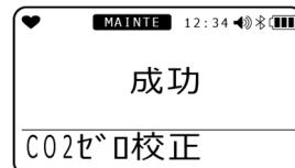
CO<sub>2</sub> ゼロ校正後の濃度が表示され、ガス校正のメニュー画面に戻ります。
