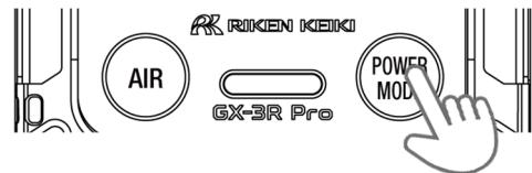
LCD 表示部が全点灯します。
