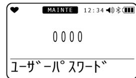
最後の桁を入力して **MODE** ボタンを押すと、「終了」が表示され、ユーザー モードメニューに戻ります。
