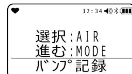
**AIR** ボタンを押すたびに、「CH<sub>4</sub>」→「O<sub>2</sub>」→「H<sub>2</sub>S」→「CO」→「CO<sub>2</sub>」→……の順に表示されます。
