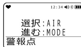
**AIR** ボタンを押すたびに、「FULL SCALE」→「WARNING」→「ALARM」→「ALARM H」→「STEL」→「TWA」→「FULL SCALE」→……の順に表示されます。
