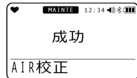
エア校正後の現在の濃度が表示され、ガス校正のメニュー画面に戻ります。
